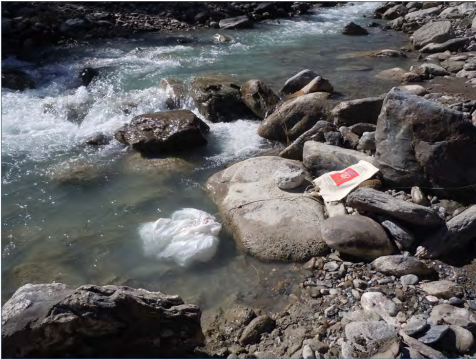
Campionatori di detrito minerale e organico sedimentabile (DMOS) immersi nel corso d'acqua e ancorati a riva. Dora di Val Veny
