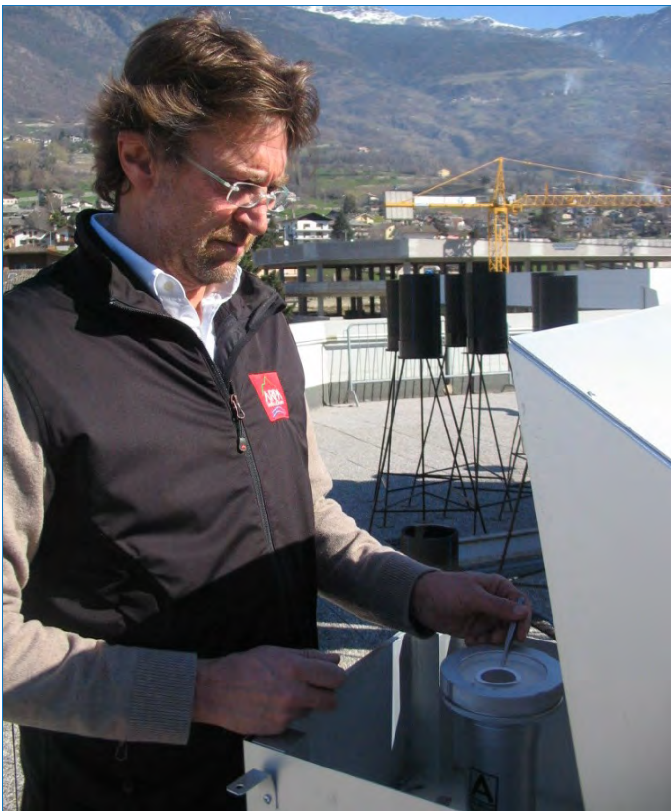
L'analisi radiometrica del particolato atmosferico campionato in continuo su filtri è uno dei cardini del sistema di monitoraggio radiometrico ambientale. Saint-Christophe – tetto sede ARPA
