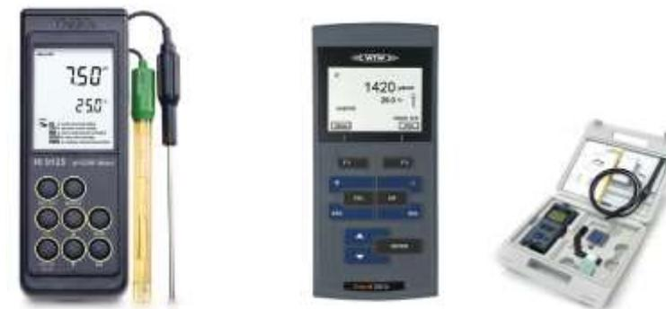
In fig. a sinistra un pHmetro HI9125. HANNA Instrument®, a destra un conducimetro WTW 3310 TechnoLab®
