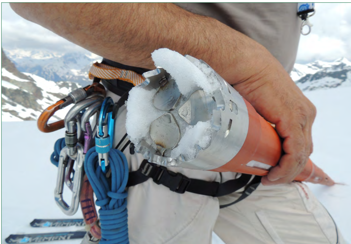
Testa del carotatore impiegato per i rilievi della densità della neve
