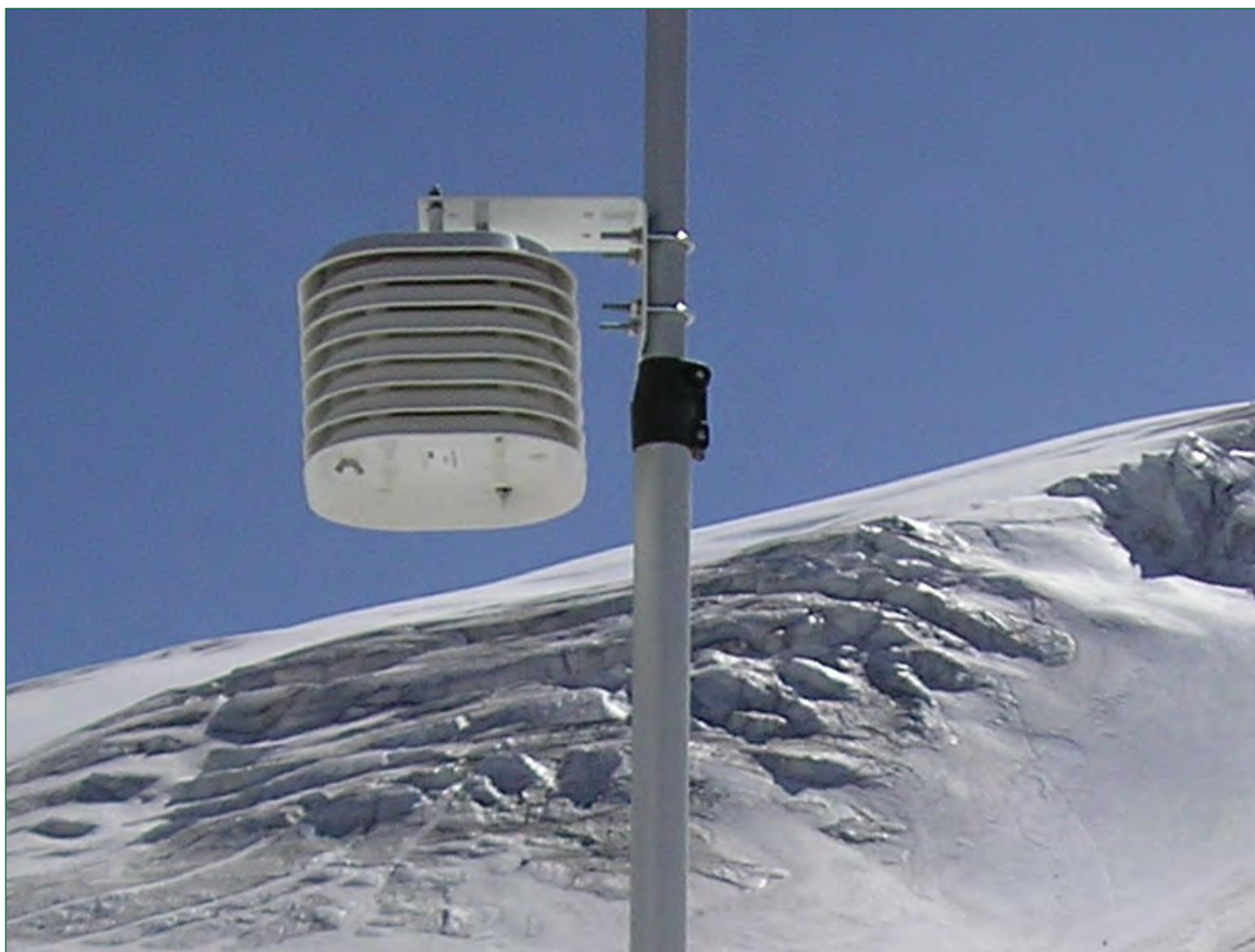
Sensore di temperatura ed umidità dell'aria all'interno di schermo anti-radiazione. Ghiacciaio di Tsa de Tsan – Valpelline
