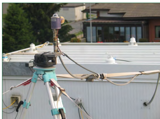
Figura 1 Alcuni strumenti partecipanti - In primo piano, l'ottica dello spettroradiometro di riferimento e, sullo sfondo, alcuni radiometri a banda larga
