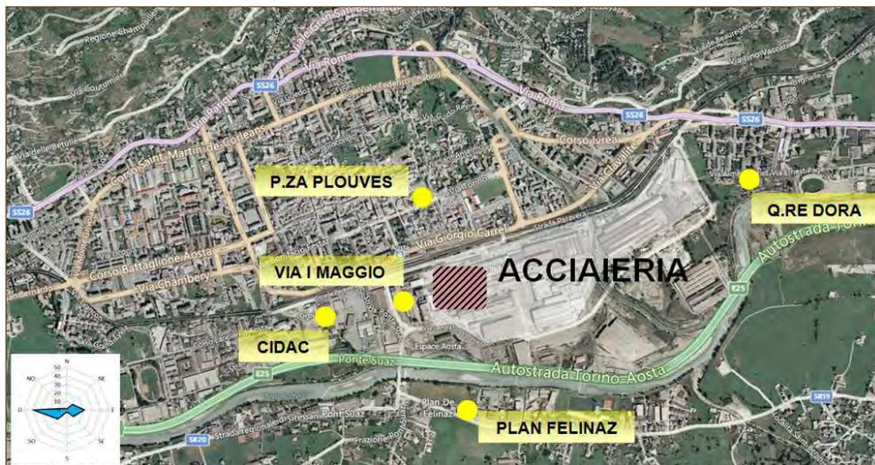
**Figura 6** Siti di monitoraggio della qualità dell'aria e delle deposizioni atmosferiche per la valutazione dell'impatto ambientale dell'acciaiera. Con riempimento tratteggiato è indicata l'area in cui sono localizzati gli impianti di fusione e affinazione dell'acciaio liquido. In basso a sinistra è riportata la direzione prevalente dei venti nella piana di Aosta.
