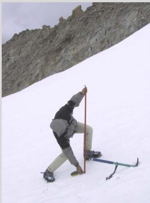
Foto 11: Misura dell'ablazione estiva lungo una palina
