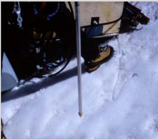
Foto 4: Segmento terminale della sonda impiegata per la realizzazione dei fori tramite vapore
