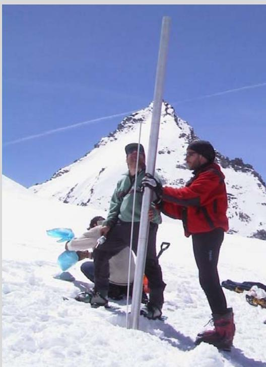
Foto 8: Carotaggio della superficie del ghiacciaio
