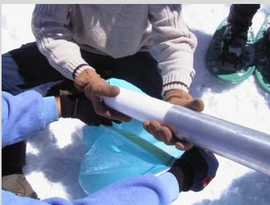
Foto 9: Estrazione e pesatura della carota
