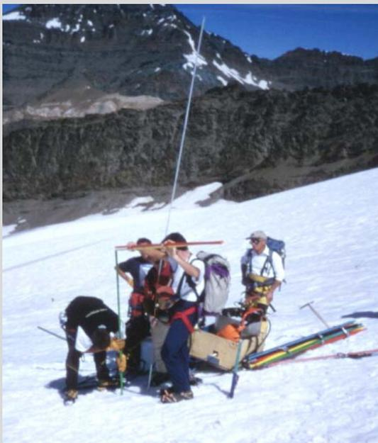
Foto 6: Inserimento della palina ablatometrica nel foro praticato sul ghiacciaio
