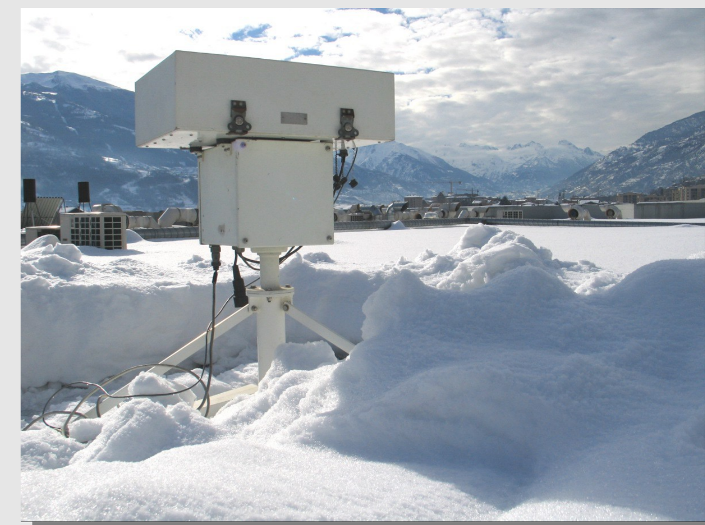
Figura 1 (sinistra), interconfronto tra lo spettroradiometro Bentham e lo standard europeo QASUME. Figura 2 (destra), lo spettrofotometro Brewer.
