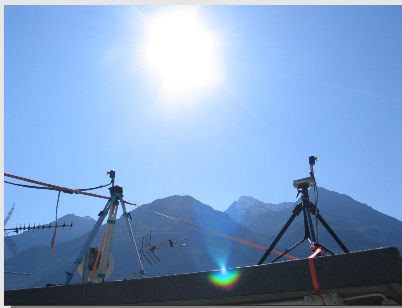
Figura 1 (sinistra), interconfronto tra lo spettroradiometro Bentham e lo standard europeo QASUME. Figura 2 (destra), lo spettrofotometro Brewer.
