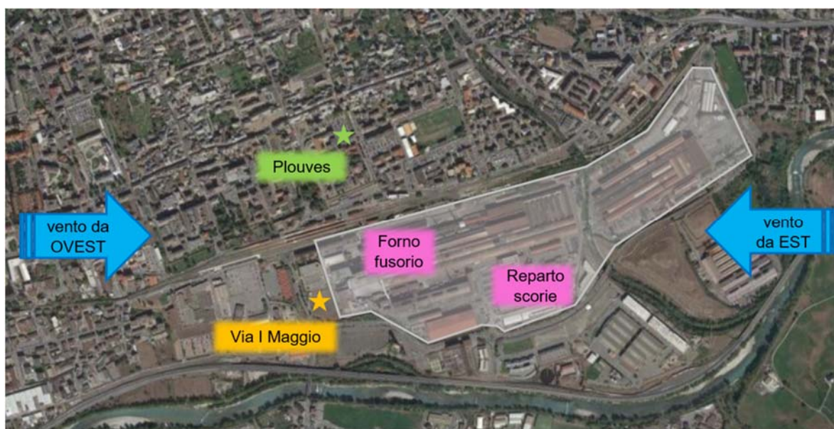
Figura 1 – Area occupata dallo stabilimento CAS e localizzazione delle stazioni di misura di via I Maggio (industriale) e di Plouves (fondo urbano)
