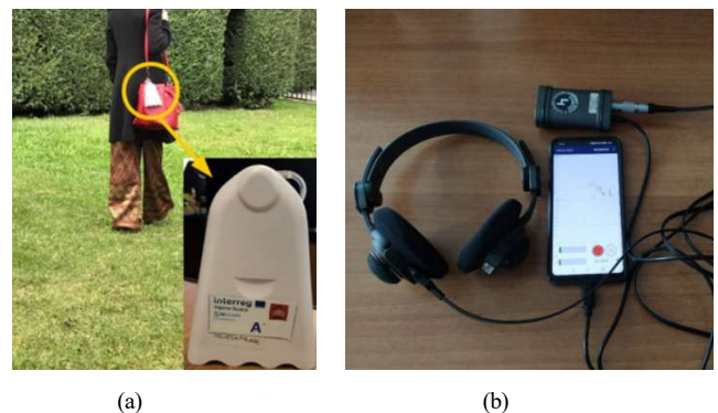
Figura 1 – Strumentazione smart utilizzata per l'attività di "Citizen Science" per la misura degli inquinanti dell'aria (a) e del rumore (b)
