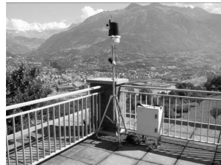
Figura 2 – Centralina fonometrica rilocabile
